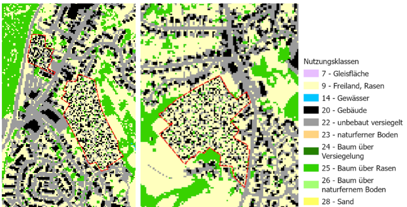
Abbildung 21: Zwei Beispiele für mit dem Mischpixelansatz gefüllte Entwicklungsflächen (rot umrandet): links Flächen der B-Plangebiete „C08 Braunsberg Ost“ und „B02 Grünestraße“, rechts „B04 Eckringhausen“.
